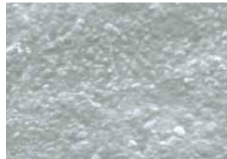
Prise- REM de la surface de C-Fill MH
